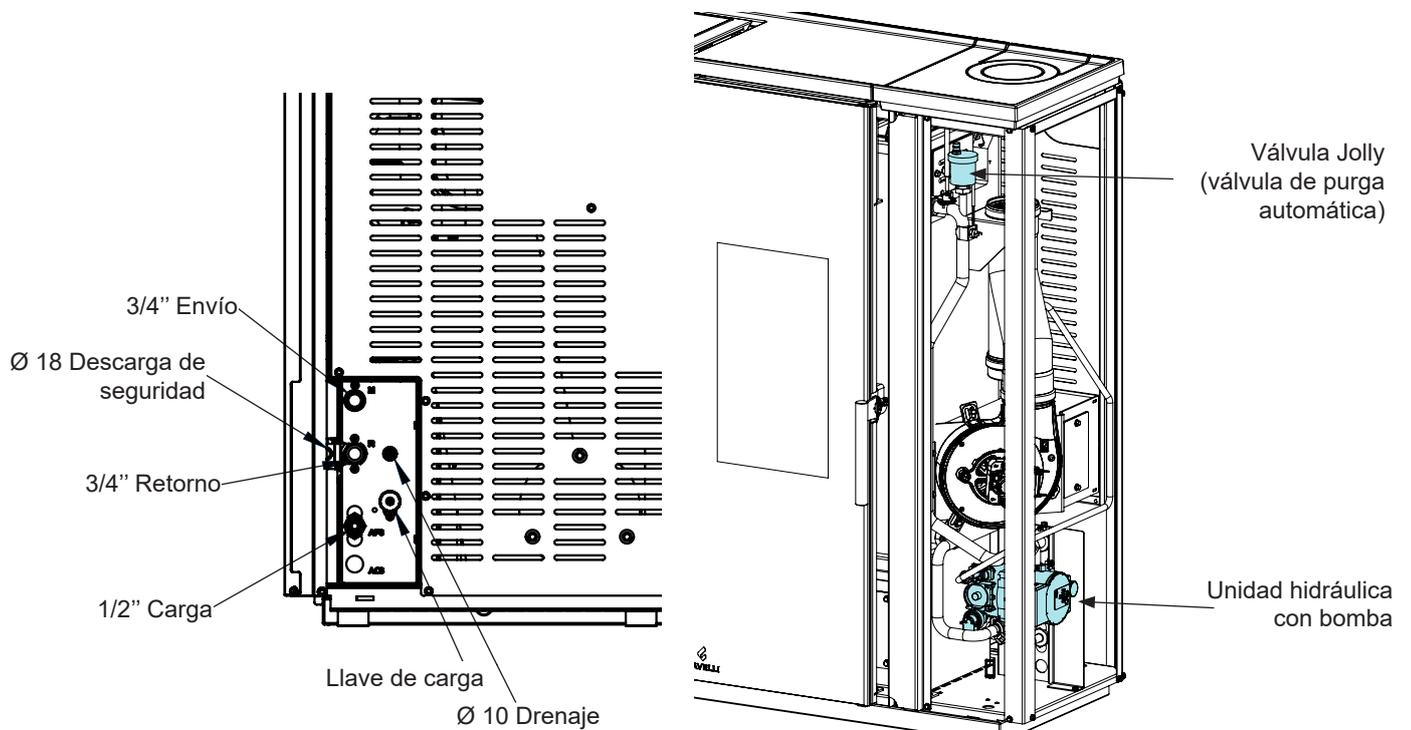
Conecte la estufa a la instalación hidráulica de manera que no se vincule excesivamente, para que pueda realizar ligeros desplazamientos.
