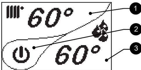
1. Indica la temperatura del agua del puffer de acumulación (si el termostato está conectado al puffer, indica si este requiere el calentamiento del agua sanitaria con ON t.ext., o bien no, con OFF t.ext.).
