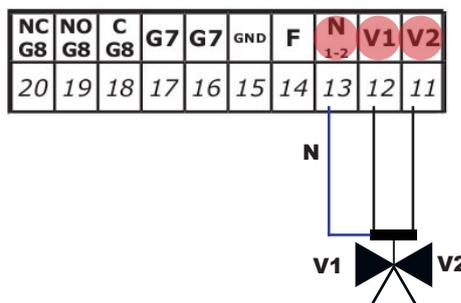
**Conexiones para esquema 1 (depósito de ACS)**
