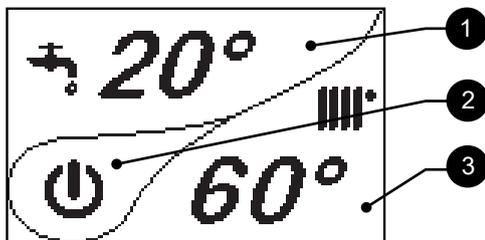
1. Indica la temperatura de la caldera de ACS que se desea mantener (si el termostato está conectado a la caldera, indica si este requiere el calentamiento del agua sanitaria con ON t.ext., o bien no, con OFF t.ext.).
