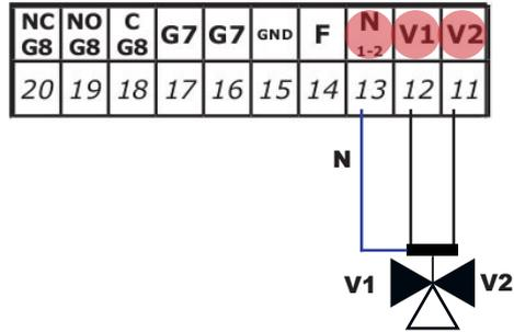
**Conexiones para esquema 2 (puffer)**
