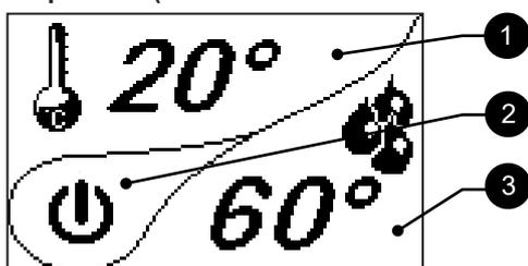
1. Indica la temperatura ambiente medida por el PDA (si el termostato externo está conectado, indica si requiere el encendido con ON t.ext o el apagado de la estufa con OFF t.ext).
