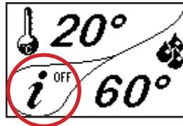
En esta condición, pulsando la tecla CONFIRMAR se puede leer el detalle del aviso: «Puertas y cajón de ceniza abiertos». Si la puerta de la cámara de combustión, la tapa del depósito de pellets y/o el cajón de ceniza no se cierran en 1 minuto, la estufa se apaga, señalizando la ALARMA 07.
